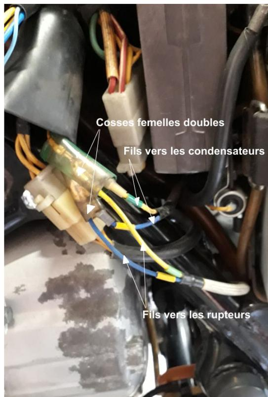
**Débrancher les condensateurs.** On peut les déposer, mais les débrancher est nécessaire et suffisant.
