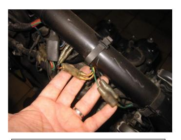
Note: le boîtier et sa patte de fixation sont électriquement isolés du circuit.
