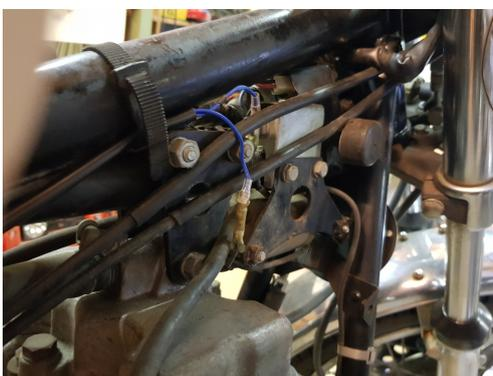
**Condensateur** : le condensateur se trouve à côté du rupteur. Il faut le débrancher, ou le déposer.
